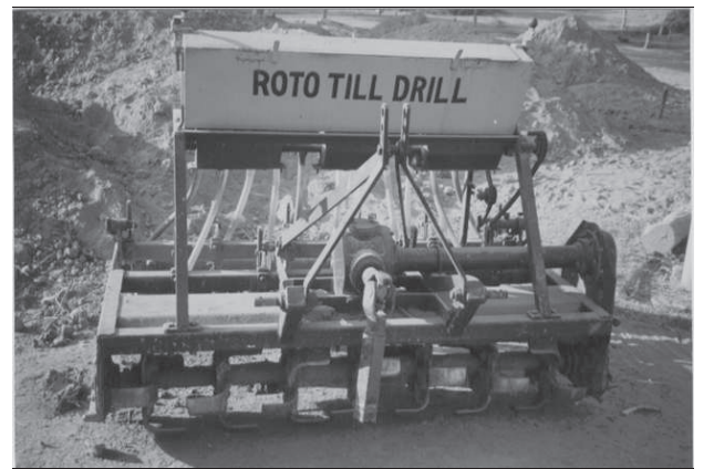
चित्र 3.12 : रोटो टिल ड्रिल - एक अत्याधुनिक कृषि उपकरण
