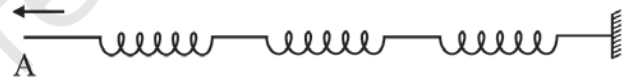
चित्र 14.1 एक-दूसरे से संबद्ध कमानियों का संग्रह। सिरे A को यकायक खींचा जाता है; तब विक्षोभ दूसरे सिरे तक संचरित हो जाता है।
