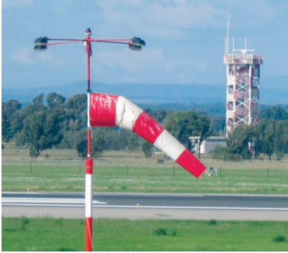
شکل 2.10: دائیں - باد پیم (Anemometer)؛ بائیں - پختہ زمینی سطح (Tarmac) پر باد نما (Wind Vane)
