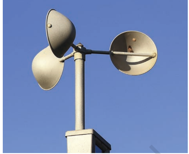
شکل 2.10: دائیں - باد پیم (Anemometer)؛ بائیں - پختہ زمینی سطح (Tarmac) پر باد نما (Wind Vane)
