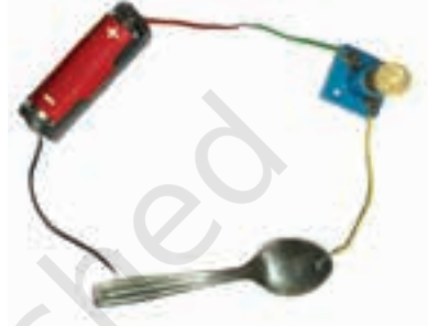
चित्र 3.15 — (ख) विद्युत चालन परीक्षण-यंत्र का उपयोग करके पदार्थ की पहचान
