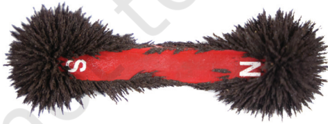
आकृती 4.4: बार चुंबकाक चिकटून आशिल्ले लोखणाचें तुकडे
